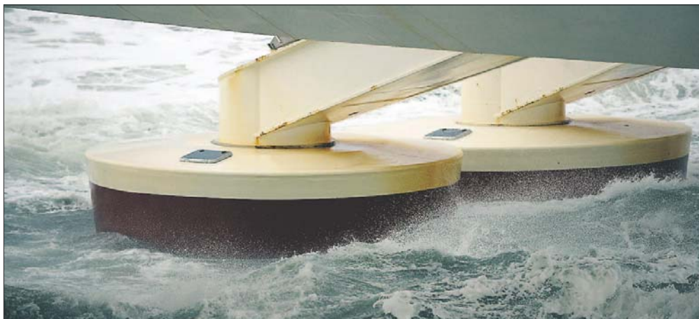
Anlæggets nuværende flydere, som bevæger sig op og ned i bølgerne, har en diameter på fem meter. Nu skal der monteres yderligere to flydere med en diameter på seks meter for at undersøge, om det øger energjudtaget.
